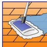
Hierzu satten Produktfilm mittels Gartenspritze vollflächig aufsprühen. Anschließend mit Wischer verteilen. Bei farbig pigmentierten Fugmaterialien ist der Vorgang nach einer 1-stündigen Trocknungszeit zu wiederholen.
